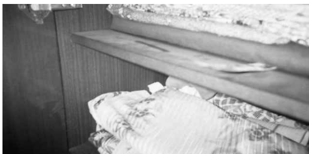
Фото 4. Поражение полок шкафа и находящегося в нём белья грибами-деструкторами без признаков спороношения
